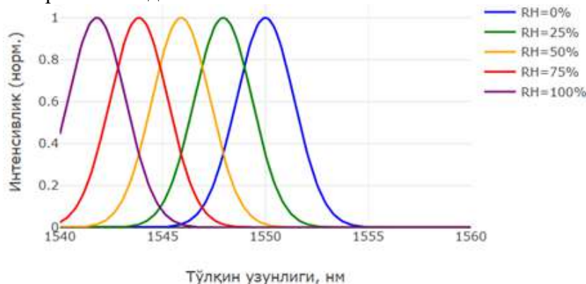
Рис. 1. Изменения спектра передачи Фабри-Перо при изменении влажности
