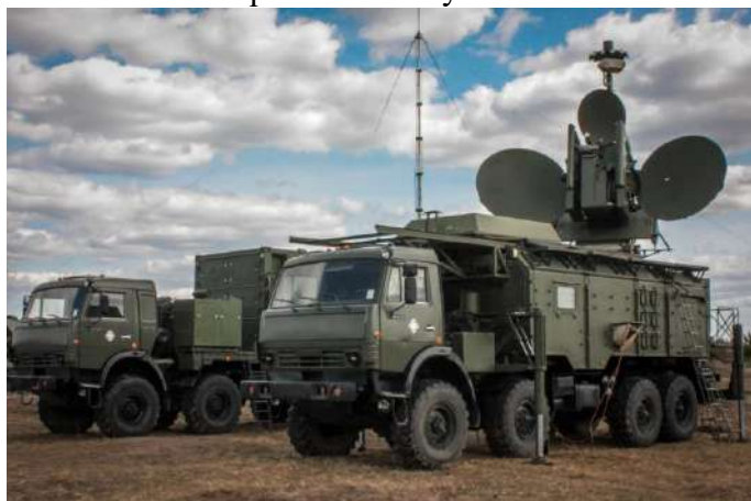
2-rasm. "Krasuxa-4" radioelektron tizimlari qo'llanilishi
