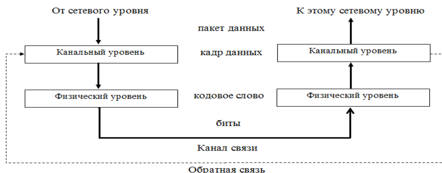
Рис.-2. Функциональная структура звена передачи данных
