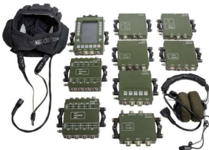
Рис. 3. Внешний вид блоков из состава УКУС на фоне танкового шлемофона типа ТШ-4 и гарнитуры ГВШ-Б-3
