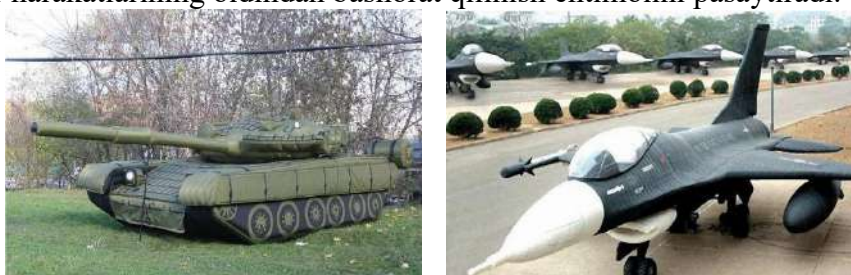
2-rasm. Yuqori darajada detallashtirilgan pnevmatik harbiy texnikalar maketi
