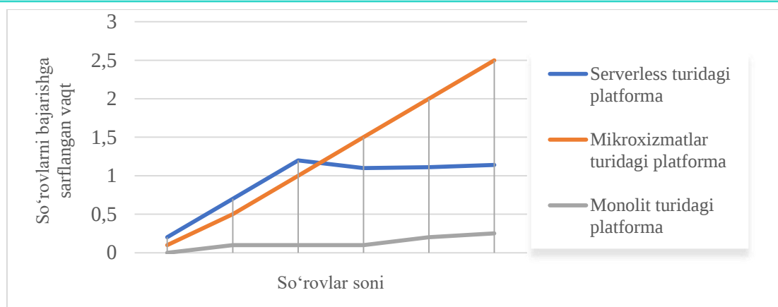
4-rasm. Uchta arxitektura usulidan foydalanib ishlab chiqilgan web platformalardagi mijozlarning so'rovlariga qaytariladigan javoblarning kechikish vaqti bo'yicha solishtirish diagrammasi
